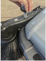
4.调节主刷的高度,调节主刷高度把手的档位使主刷的高度处在合适的高度,增强清扫效果。
