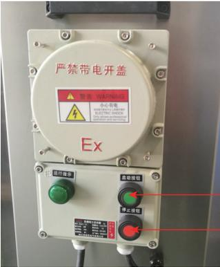
使用说明：接好三相电源（AC380V）及接地线，开启风机和气泵启动按钮，红色为停止按钮。
